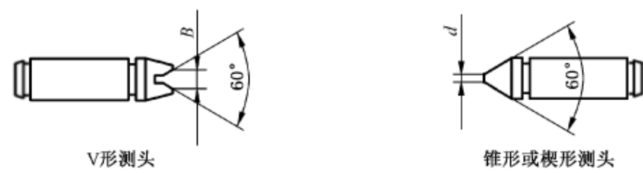
图 22 电子螺纹千分尺的可换测头
